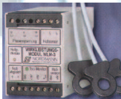
Bild 1: Das Wirkleistungsmodul WLM-3 ermöglicht die Überwachung von Bohrem mit Durchmessern ab 1,8 mm auf Spindeln mit einer Antriebsleistung von 15 kW oder von Bohrem mit 0,75 mm Durchmesser auf Spindeln mit 3,5 kW Antriebsleistung.
