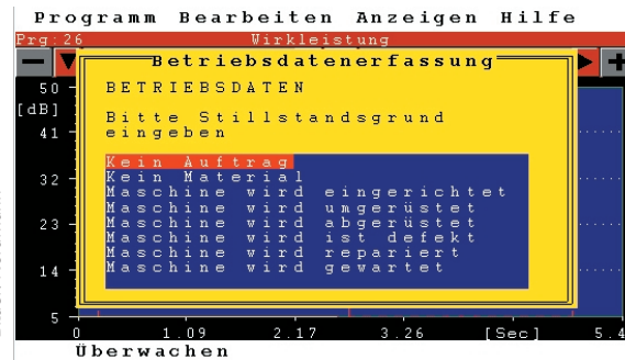
Bild 6: Die Funktion „Betriebsdatenerfassung“ bewirkt bei einem Maschinenstillstand die Abfrage des Stillstandsgrundes.
