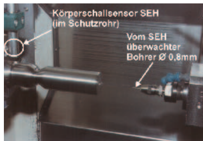
Bild 3: Überwachung eines 0,8-mm-Bohrers mit dem Sensor SEH mit einer Körperschallaufnahme vom rotierenden Werkstück. Der die Schallwellen leitende Kühlschmierstoffstrahl ist abgestellt.
