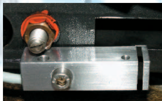
Bild 2: Der Kraftaufnehmer erfasst die Vorschubkraft des jeweiligen Werkzeuges über die Oberflächendehnung des Kulissenhebels eines Mehrspindel-Drehautomaten; die Montage dieses Dehnungs- und Kraftsensors ist relativ einfach.
