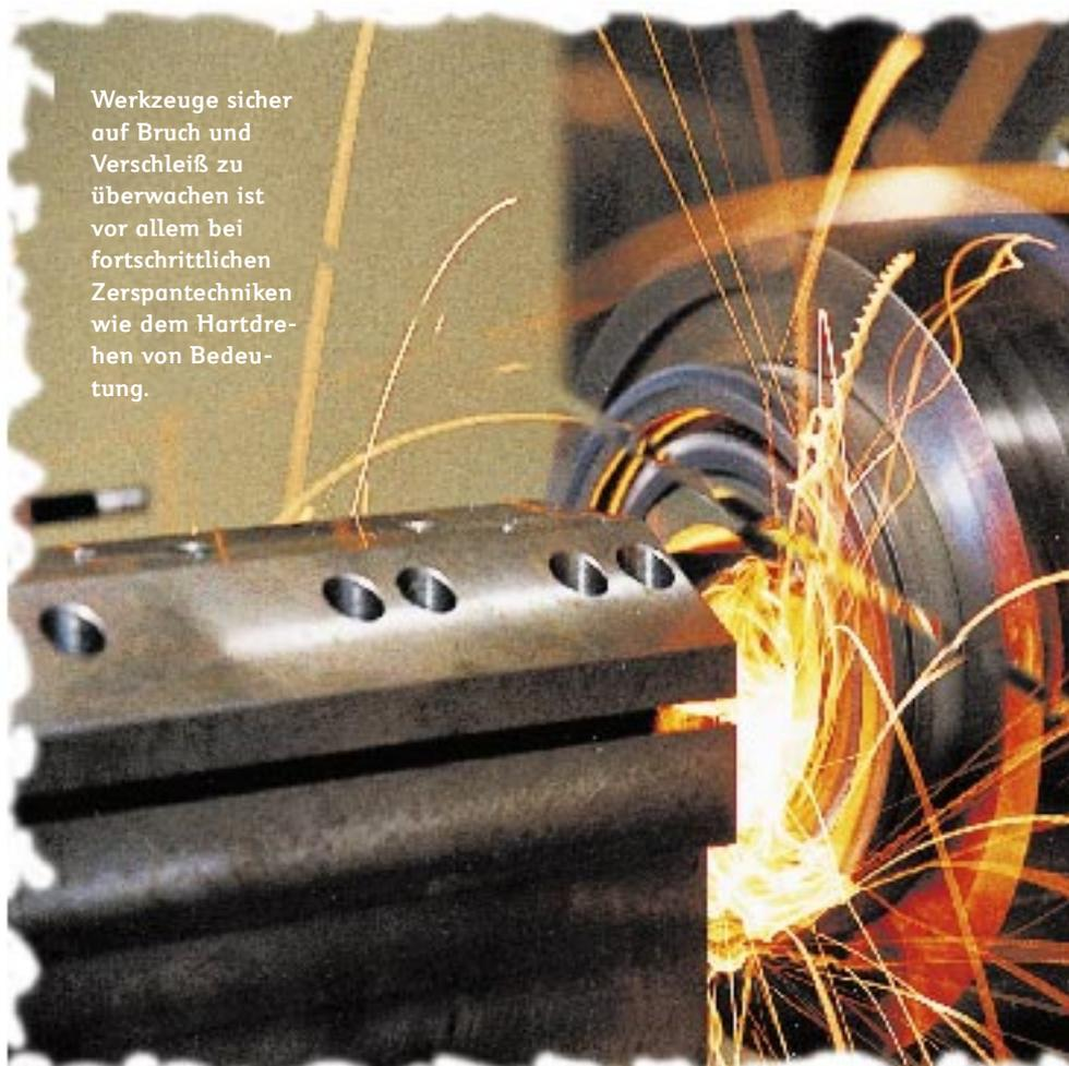
Werkzeuge sicher auf Bruch und Verschleiß zu überwachen ist vor allem bei fortschrittlichen Zerspantechniken wie dem Harddrehen von Bedeutung.
