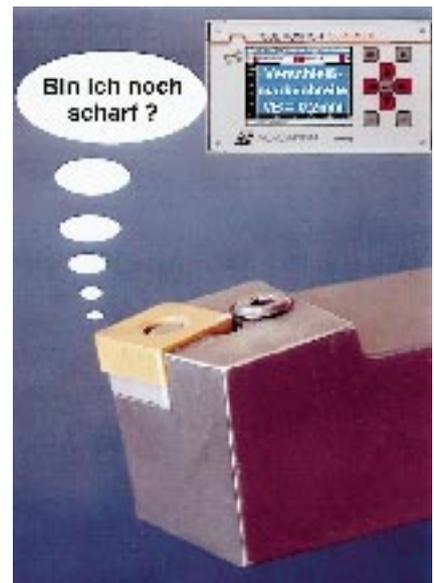
Bild 1: Die Wendeschneidplatte des intelligenten Drehmeißels „spürt“ den Verschleiß selbst.
