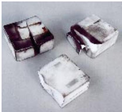
**Bild 4:** Solche Brüche, die eine vollständige Ausnutzung aller acht Schneidenecken verhindern, lassen sich mit Dünnschichtsensoren auf der Freifläche vermeiden.
