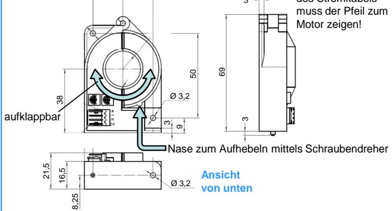
Beim Durchfädeln des Stromkabels muss der Pfeil zum Motor zeigen!
