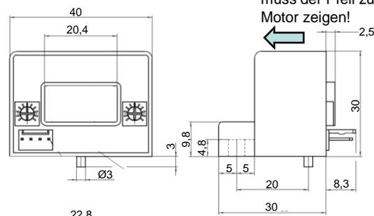
Beim Durchfädeln des Stromkabels muss der Pfeil zum Motor zeigen!
