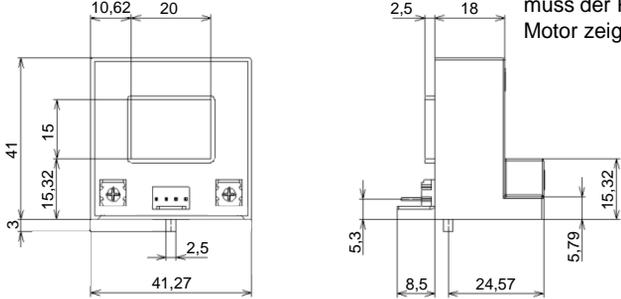
Beim Durchfädeln des Stromkabels muss der Pfeil zum Motor zeigen!
