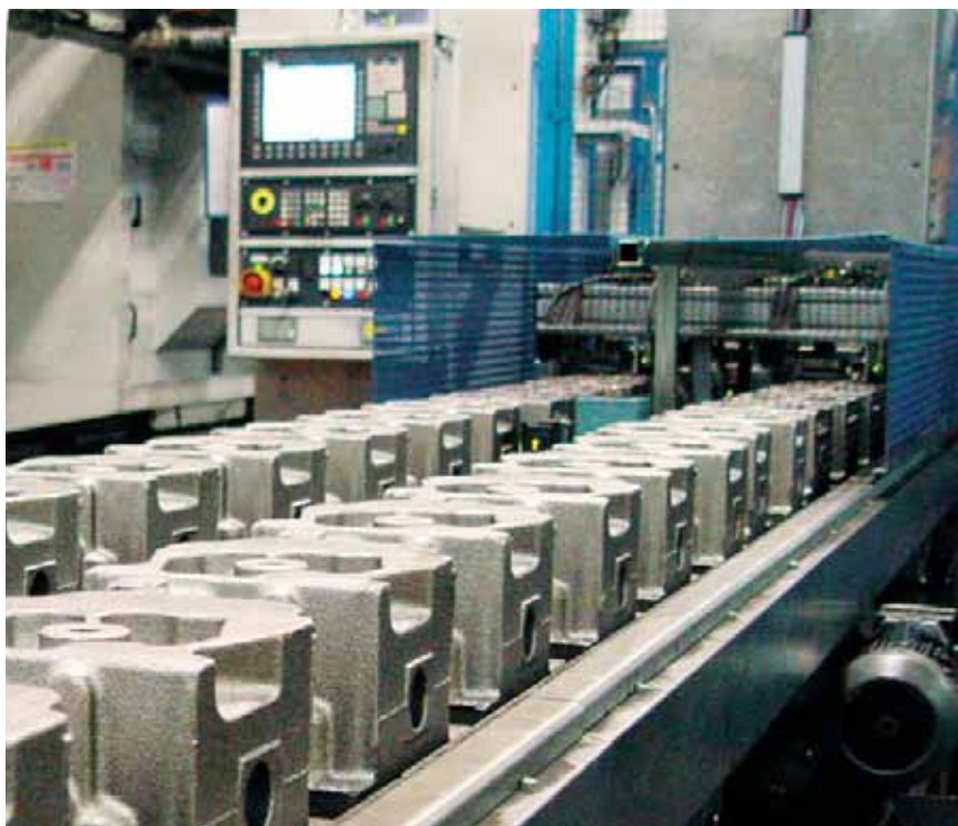
1 Produktivität braucht Prozesssicherheit: Die möglichst störungsfreie Großserienfertigung von Zylinderköpfen auf Transferstraßen ist bei optimierten Taktzeiten auch eine besondere Herausforderung an die Prozessüberwachung
