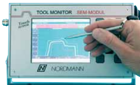
4 Zerspanen auf der Ideallinie: Mittels eines Touch-Pen kann die eingelernte Hüllkurve geändert werden, was die Anzahl der Fehlalarme reduziert, ohne die Werkzeugüberwachung insgesamt unempfindlich zu stellen
