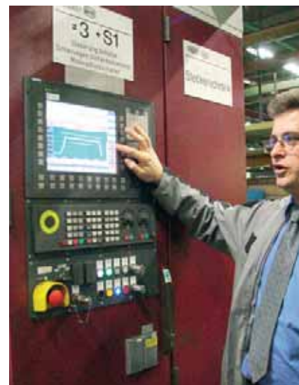
5 Wie es euch gefällt: Das eingelernte Toleranzband kann auch mittels Softkeys an veränderte Zerspanungsbedingungen angepasst werden; hier Wolfgang Engelhardt beim Ändern der Hüllkurve am Bedien-Panel »OP 12« von Siemens
