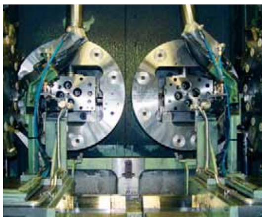
■ Orwell an der Schneide: Die Überwachung des Plandrehens der Zylinderköpfe erweist sich auf Grund unsteter Zerspanungsbedingungen und eines unterbrochenen Schnitts als besonders diffizil; als Lösung diente die Dynamikauswertung der Wirkleistung
