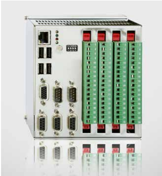
2 Die Zentraleinheit des Tool-Monitors SEM-Modul-e ist mit 122 mm × 133 mm × 100 mm nur halb so groß wie das SEM-Modul. Es lassen sich bis zu acht analoge Sensoren sowie 24 Profibus-Kanäle anschließen. Zudem sind USB-, Ethernet-, VGA-, CAN-Bus- und RS232-Schnittstellen vorhanden (© Nordmann)
