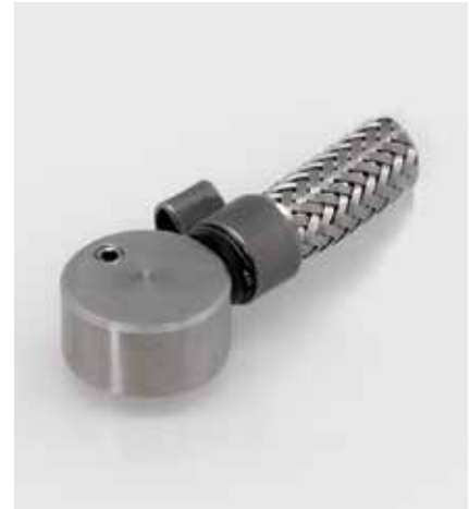
3 Piezoelektrischer Dehnungsaufnehmer für hochempfindliche Kraftmessungen in kompakter Ausführung (16 mm Durchmesser, 8 mm Höhe) für kleine Bauräume. Befestigt wird er mittels Spezialkleber, sodass ein aufwendiges Bohren, etwa in gehärtete Oberflächen, entfällt (© Nordmann)
