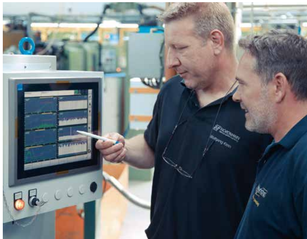
1 Der Autor dieses Beitrags (links) und Rainer Wendling, Produktionsentwickler beim Anwender Heinrichs, werten die Kurvenverläufe eines aktuellen Mehrspindel-Drehprozesses aus. Bei Heinrichs bedient man den Tool-Monitor SEM-Modul-e über einen nachgerüsteten Industrie-Computer mit 20“-Touchscreen (© Nordmann)
