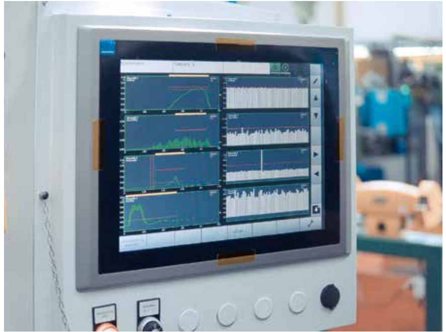
4 Visualisierung des Tool-Monitors SEM-Modul-e. Links im Display befinden sich die verschiedenen Kraft-Messstellen, rechts daneben ist der jeweils zugehörige Trend der Spitzenwerte erkennbar. Position, Größe, Anzahl und Farbe der einzelnen Messfenster lassen sich frei konfigurieren (© Nordmann)
